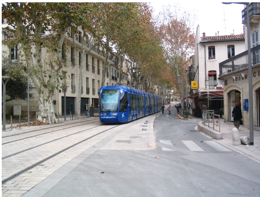
Afbeelding 16: de tram in Montpellier; trams van 43 meter lengte en met een breedte van 2,65 rijden op eigen baan door een volledig heringerichte binnenstad. Foto TransTec.
